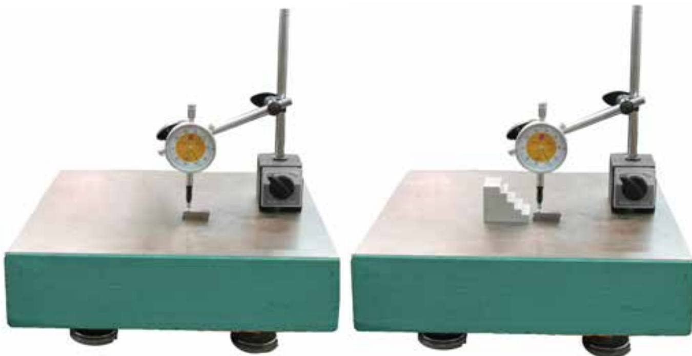
شکل ۸-۱۸- تنظیم ساعت اندازه‌گیری
