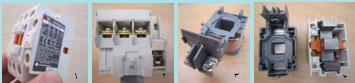
شکل ۵-۳۷ تصویر داخلی کنتاکتور.
