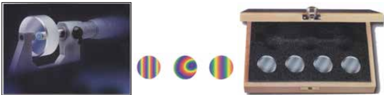
شکل ۲۲-۵- کنترل سطح فکین میکرومتر با نشیبه تخت نوری
