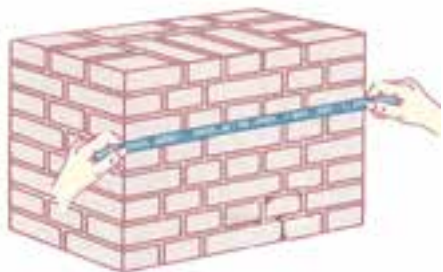
شکل ۱-۳- اندازه‌گیری به وسیله‌ی متر
