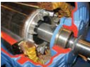
شکل ۴-۲۲ نماهای برش خورده موتور آسنکرون سه فاز.
