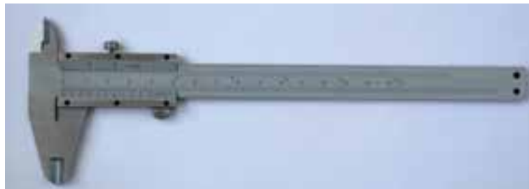
شکل ۴-۱- کولیس ورنیه
