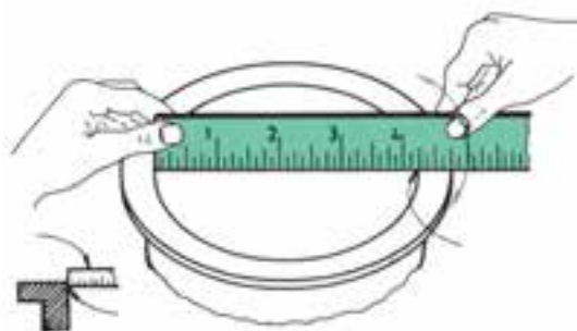
شکل ۱۲-۳ تعیین قطر داخلی با خطکش
