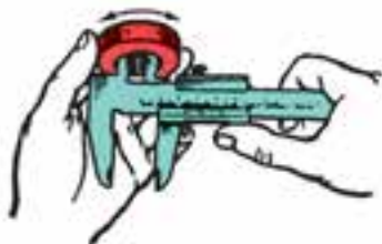
شکل ۴-۹- چرخاندن شاخک‌های کولیس در داخل کار
