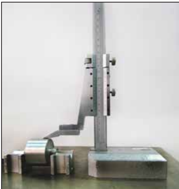
شکل ۱۲-۴ کاربرد کولیس ورنیه ارتفاع‌سنج
