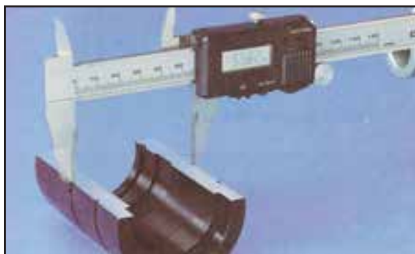
شکل ۲۲-۴ اندازه‌گیری با کولیس دیجیتالی
