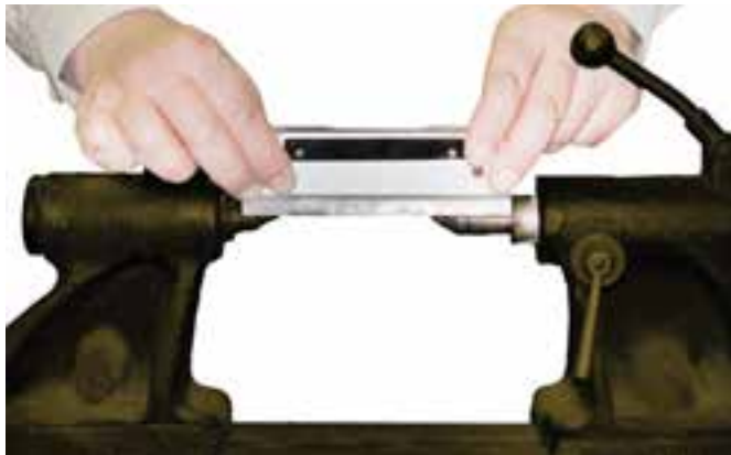
شکل ۵-۲- کنترل هم راستایی محور های دستگاه مرغک
