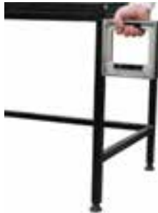
شکل ۲-۲- کنترل شیب پایه‌ی میز
