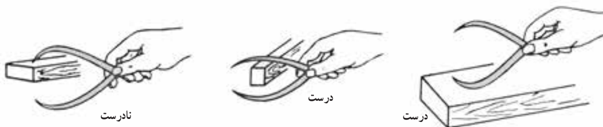
شکل ۲-۲۷- تنظیم دهانه پرگار انتقال اندازه خارج
