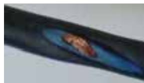
شکل ۱۶-۲ کابلی که روکش عایق آن با شیئی برنده بریده شده است.
