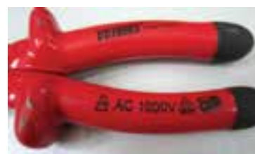
(الف) دسته عایق انبردست (در برابر ۱۰۰۰ ولت)
