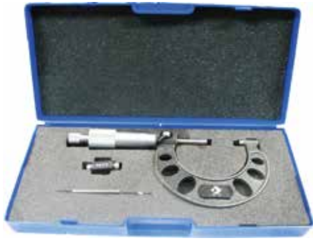
شکل ۱۵-۱- میکرومتر با گستره اندازه‌گیری (۲۵-۵۰) میلی‌متر
