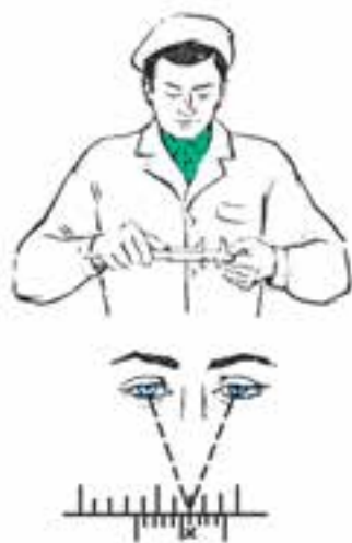
شکل ۱۹-۱- خطای دید در اندازه‌گیری
