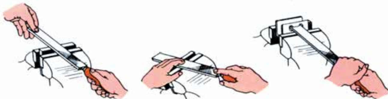
شکل ۵-۶ - استفاده از دست چپ در سوهان‌های متوسط
