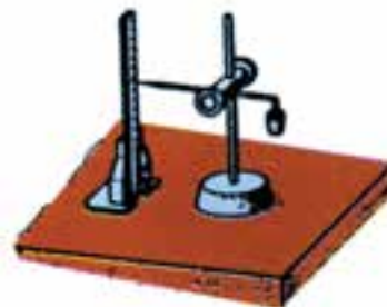
شکل ۳-۶- تنظیم ارتفاع سوزن
