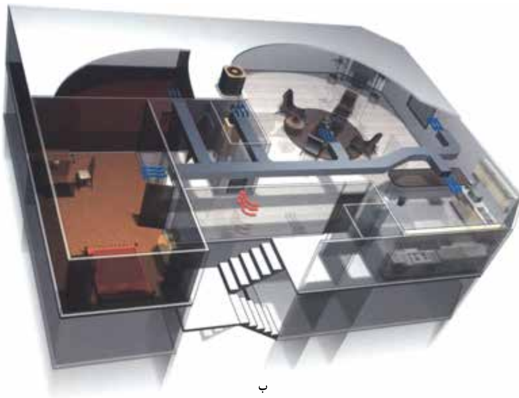
شکل ۱۱-۲۴- الف) یک نمونه داکت اسپلیت ب) داکت اسپلیت و کانال کشی فضا
