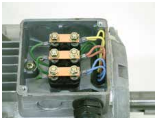
شکل ۱۴-۹- اتصال مثلث سیم پیچ های موتور
