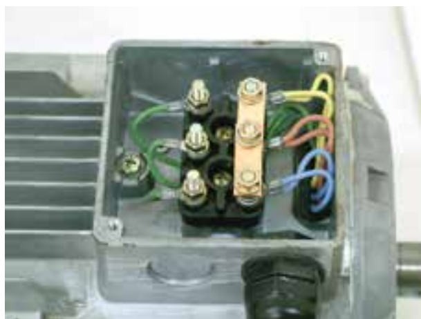
شکل ۹-۱۳- اتصال ستاره سیم‌پیچ‌های موتور
