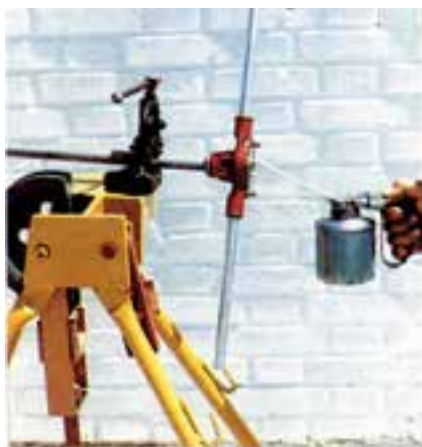
روغن زدن حین حدیده کاری
