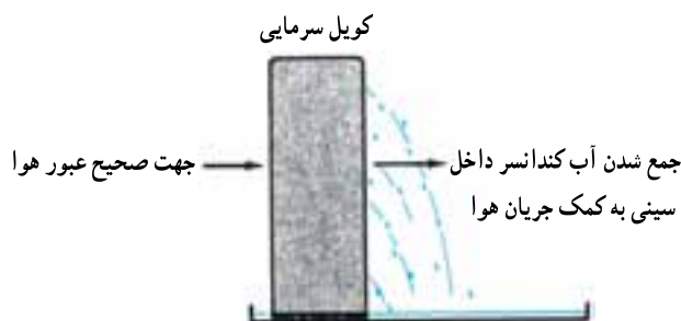
شکل ۱۴-۶ موقعیت نصب درست سینی کف اواپراتور
