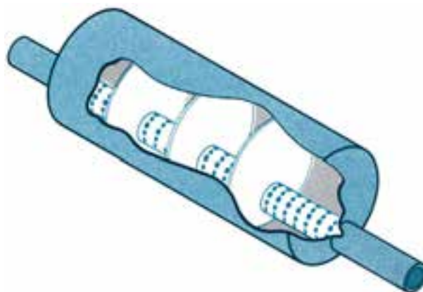
شکل ۲۱-۷- شکل برش خورده یک موفلر (صدا خفه‌کن)
