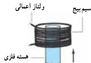
شکل ۱۰-۷- سیم پیچ به علاوه هسته فلزی شیر برقی
