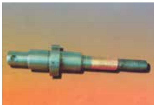
شکل ۴۲- ۵- شافت یک دستگاه پمپ
