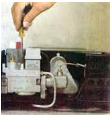
شکل ۳۲-۵ - تنظیم شعله‌ی پیلوت
