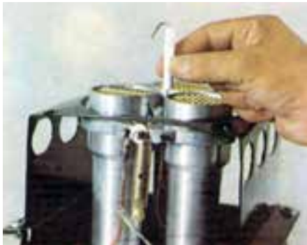
شکل ۳۵-۵ - تعویض الکتروود جرقه
