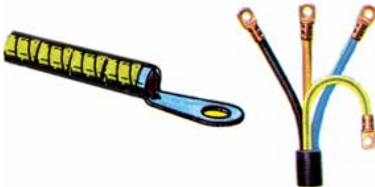
شکل ۴-۴ سه روش اتصال کابل شو به کابل
