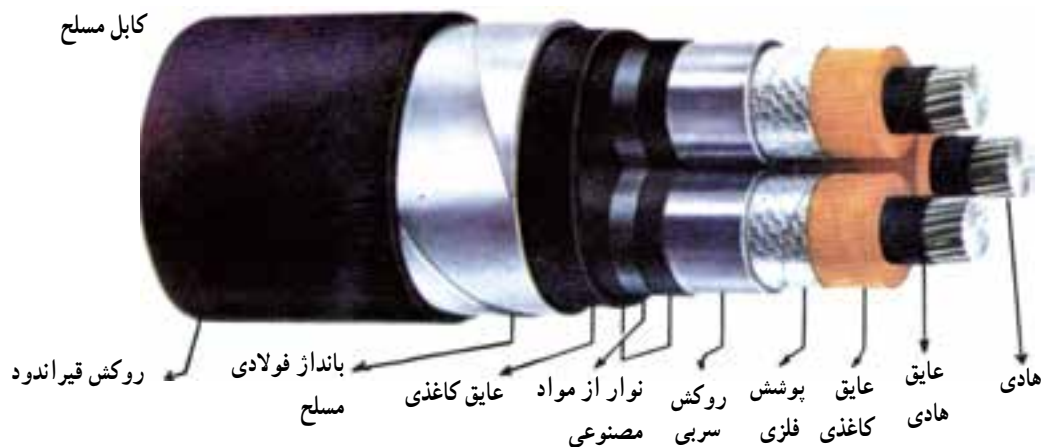
شکل ۲-۴ – ساختمان کابل فشار قوی
