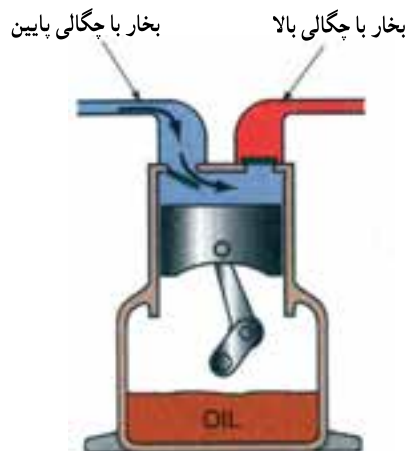
شکل ۳-۴- پیستون رو به پایین حرکت می کند.
