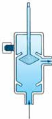
شکل ۱۵-۲- با چرخش نیم تا یک دور در جهت عقربه‌های ساعت در موقعیت back seated، مسیر گِیج نیز باز می‌شود.
