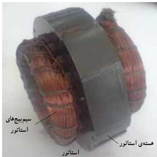
شکل ۱-۲ استاتور و روتور یک کمپرسور بسته تناوبی
