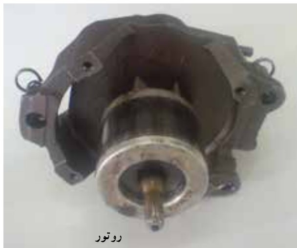
شکل ۱-۲ استاتور و روتور یک کمپرسور بسته تناوبی
