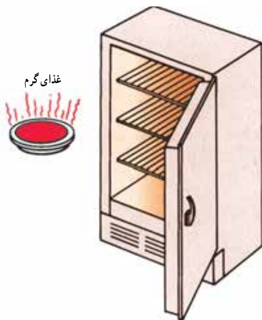
شکل ۲-۴- غذای برداشته شده از اتاق یا اجاق، به یخچال گرما اضافه می‌کند که به منزله نفوذ گرما تلقی می‌شود. این گرمای اضافه شده باید گرفته شود و ال‌دمای داخل یخچال بالا خواهد رفت.
