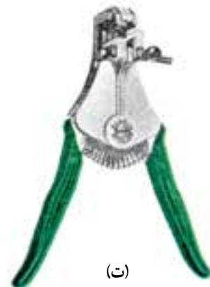
شکل ۱۲-۲- الف و ت- نمای ظاهری دو سیم‌لخت‌کن ب و پ- سیم‌لخت‌کن اتوماتیک در حال لخت کردن سیم
