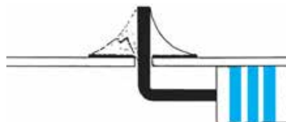
شکل ۲۱-۳- چند نمونه لحیم کاری غیر قابل قبول
