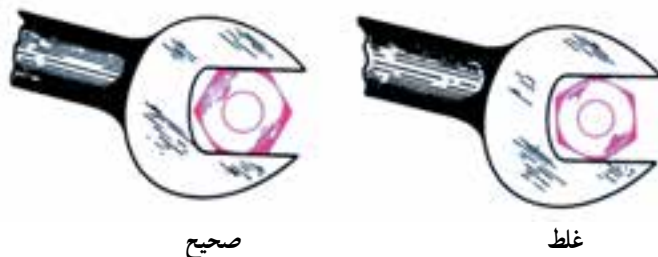
شکل ۹-۱- روش انتخاب آچار مناسب برای کار
