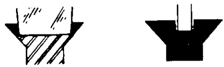
شکل ۱-۲۲ طرز قرار گرفتن صحیح نوک آچار از نظر طول و ضخامت در شیار
