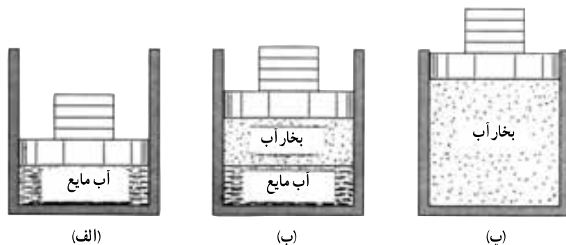
شکل ۱-۵- بخار اشباع و فشار اشباع
