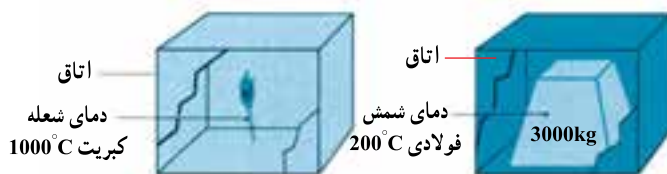
شکل ۱-۱- شعله کبریت دمای بیشتری را از شمش فولادی دارد با وجود این شمش فولادی گرمای بیشتری را در وجود خود نگه داشته و هوای اتاق را بیشتر گرم خواهد کرد.
