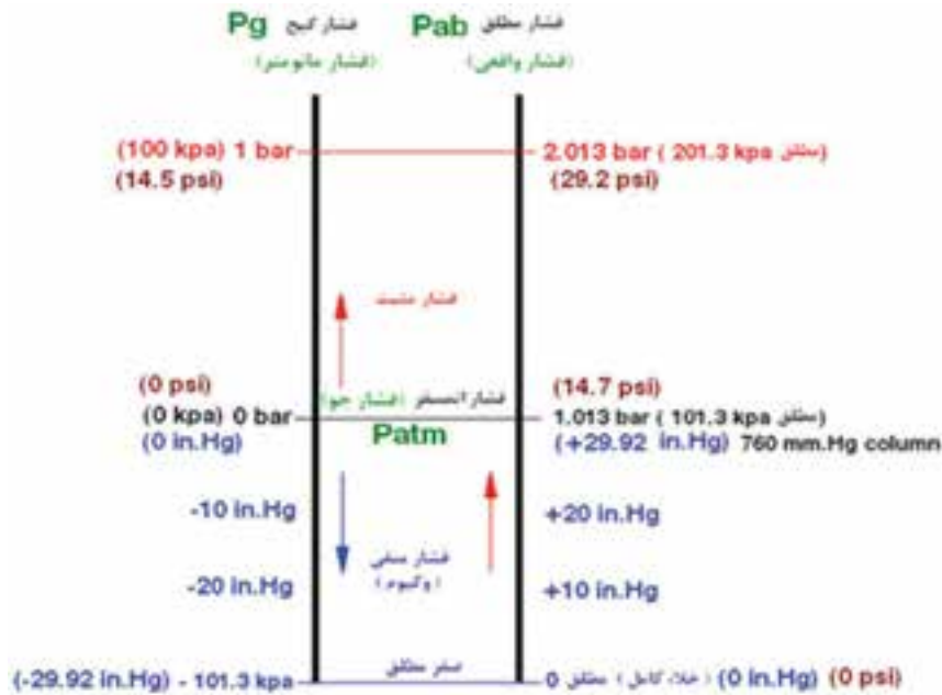
شکل ۱۴-۱- نسبت بین فشار گیج و فشار مطلق
