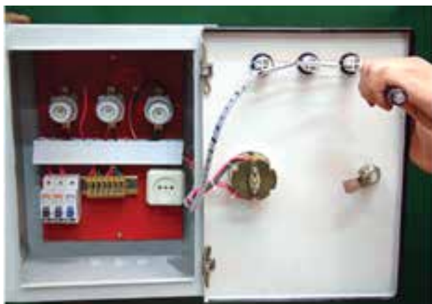
شکل ۹-۱۷- مونتاژ و تست تابلو
