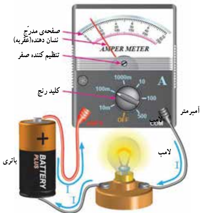
شکل ۶-۹- آمپرمتر با مصرف‌کننده به طور سری در مدار قرار می‌گیرند.
