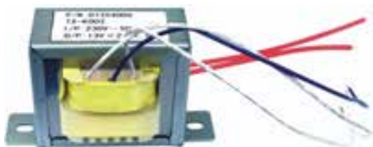
شکل ۹-۶- یک نمونه ساده ترانسفورماتور با دو سیم پیچ که به وسیله هسته آهنی در ارتباط می‌باشند.
