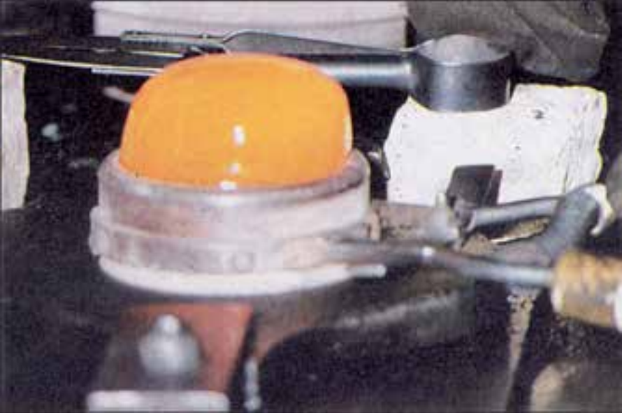
شکل ۱-۴- لقمه مذاب شیشه در شیشه‌گری دستی
