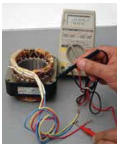
شکل ۲-۱۵- تست اتصال بدنه
