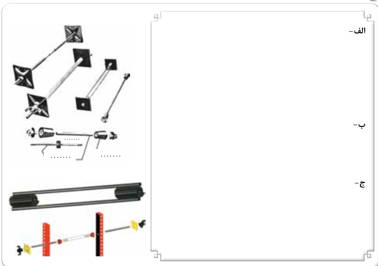
۱۳. در شکل های زیر نوع استفاده از میان بلت های فنری و اجزای مشخص شده را توضیح دهید.
