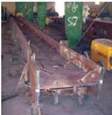
مونتاژ تیورق با تغییر مقطع در قالب
