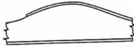
شکل ۱۱-۸- مونتاژ قائم تیرهای ماهیچه‌ای
