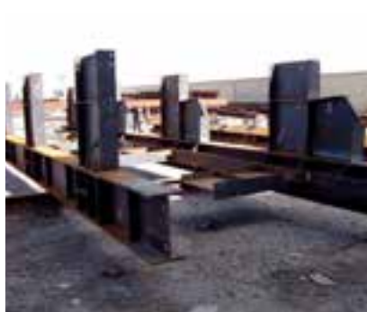
شکل ۱۱-۱۵- فیکسچر مونتاژ نهایی قطعات الما قی دستک ها روی ستون صلیبی شکل
