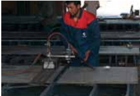
ب- عملیات برشکاری مرارتی ورق
