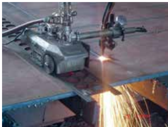
شکل ۱۱-۲- دستگاه برش ریلی
