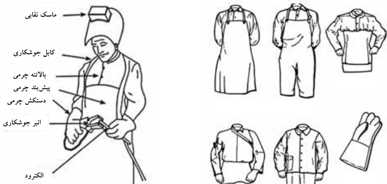
آماده شدن برای جوشکاری بالاسر
