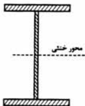
شکل ۱۱-۹- محور فنتی در تیرورق متقارن H شکل
