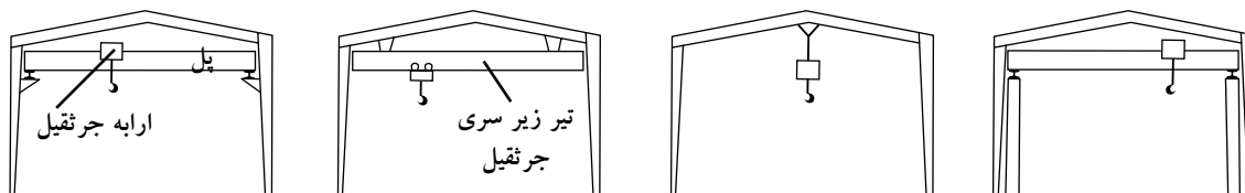
الف- قاب با انواع جرثقیل سقفی
