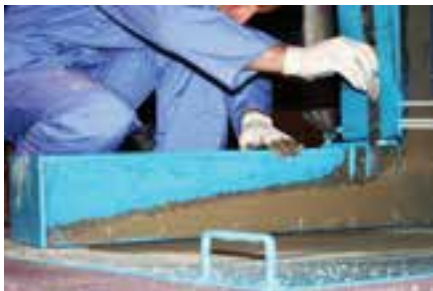
شکل ۴- نمونه‌ی اجرای آزمایشگاهی بتن خود تراکم
