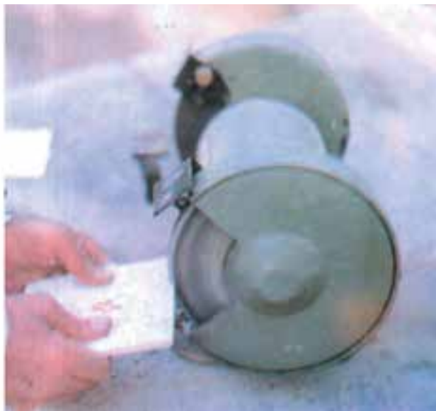
شکل ۱۱-۶- کسر کردن کناره کاشی به وسیلهی دستگاه چرخ سمباده
