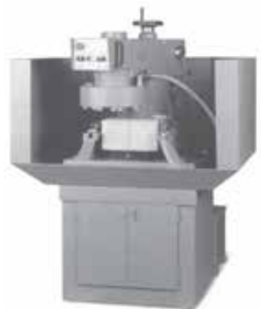
دستگاهی برای ساییدن و صیقل کردن سطوح نمونه‌های آزمایشی به منظور اندازه‌گیری دقیق مقاومت فشاری نمونه‌ها
