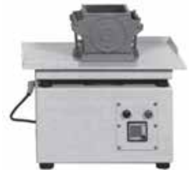
میز لرزان برای متراکم کردن نمونه‌های آزمایشی
