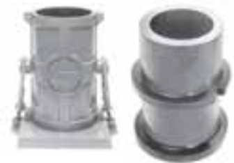
قالب نمونه‌های استوانه‌ای براساس استاندارد ASTM
