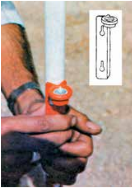
شکل ۱۰-۲- تراز نبشی و طرز استفاده از آن
