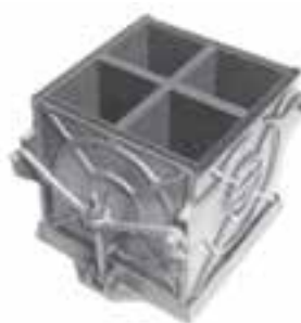
انواع قالب‌های مورد استفاده در نمونه‌گیری سیمان براساس استاندارد ASTM C109 و BS 4550
