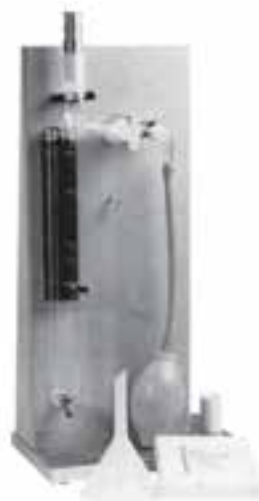
دستگاه نفوذپذیری هوای Blaine که براساس استاندارد ASTM C204 و BS 4550 و DIN 1164 کار می کند.
