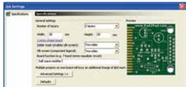
شکل ۳-۱ انتخاب مشخصات فیبر مدار چاپی
