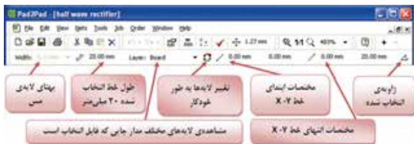
شکل ۳-۵ مشخصات زبانه‌های مربوط به نوار تعیین ابعاد
