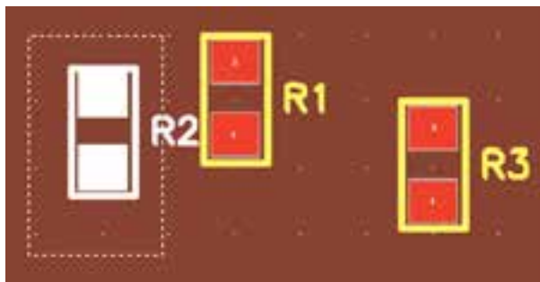
شکل ۳-۱۹ انتقال مقاومت روی فیبر مدار چاپی
