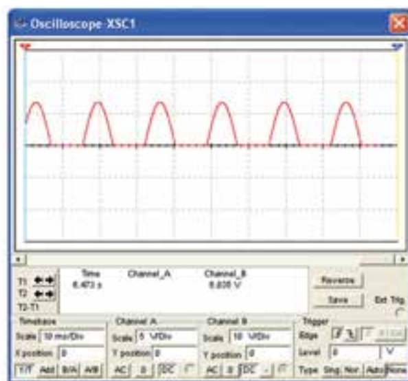
الف - مدار یک‌سوساز نیم‌موج
