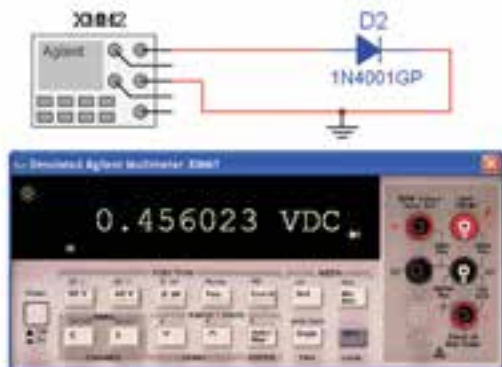
شکل ۲-۲۱ آزمایش دیود در بایاس موافق
