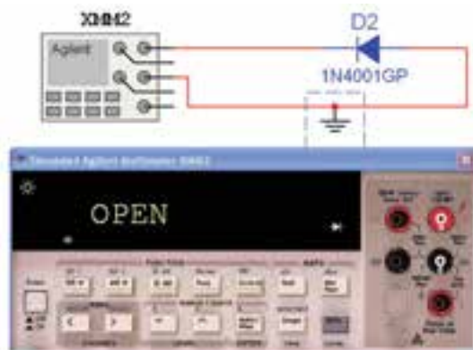
شکل ۲۲-۲ آزمایش دیود در بایاس مخالف
