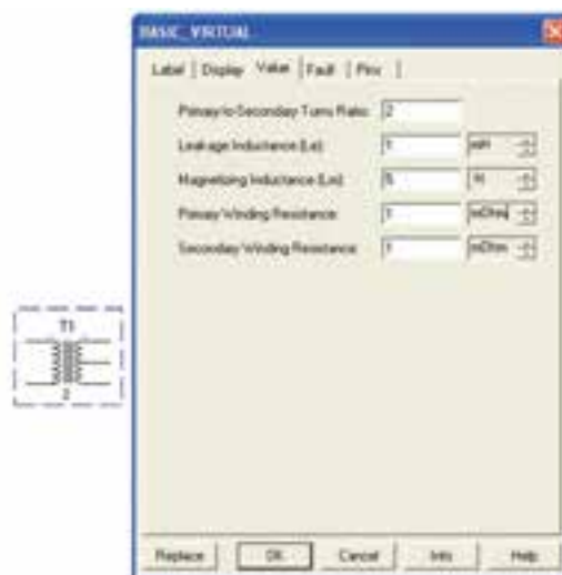
شکل ۱-۴۳ تنظیم نسبت ترانسفورماتور
