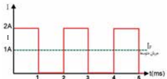
شکل ۱-۸- مقدار جریان متوسط مجاز ( I ) دیود برای موج مربعی
