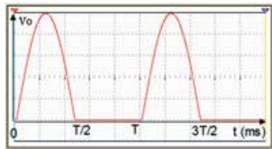
شکل ۸-۹- شکل موج خروجی مدار یکسوساز نیم موج
