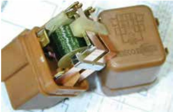
شکل ۹-۱۱- شماره پایه‌های رله روی بدنه آن حک شده است.
