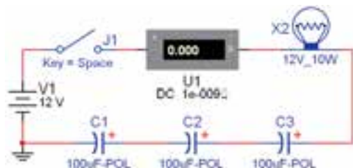
شکل ۸-۵ جریان عبوری از مدار خازن‌های سری
