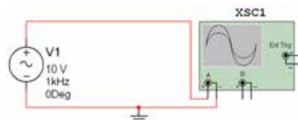
شکل ۹-۶-الف- نحوه‌ی اتصال اسیلوسکوپ به منبع
