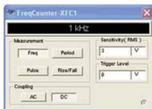
شکل ۶-۶ استفاده از فرکانس متر در اندازه‌گیری فرکانس
