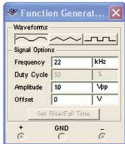
شکل ۶-۱۰ اندازه‌گیری ولتاژ مؤثر
