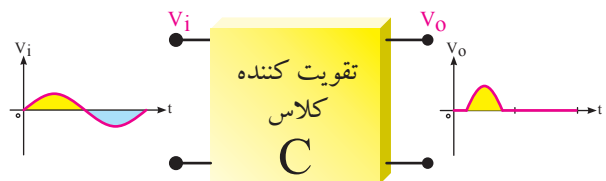
شکل ۵-۸۳ در تقویت کننده کلاس C قسمت کمی از نیم سیکل مثبت یا منفی تقویت می‌شود
