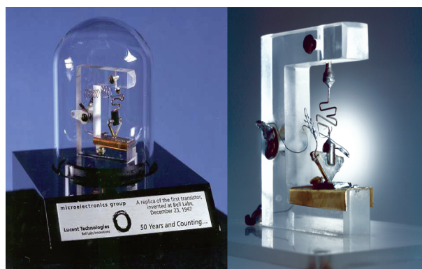
شکل ۱-۵ اولین ترانزیستور ساخته شده در سال ۱۹۴۷
