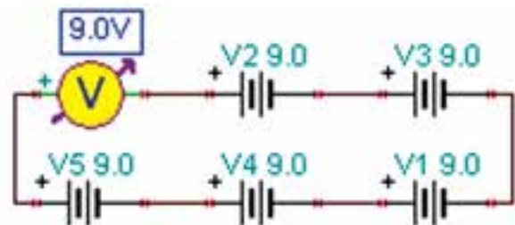
شکل ۵-۸ اتصال پنج باتری ۹ ولتی به صورت سری بدون توجه به قطب‌های آن
