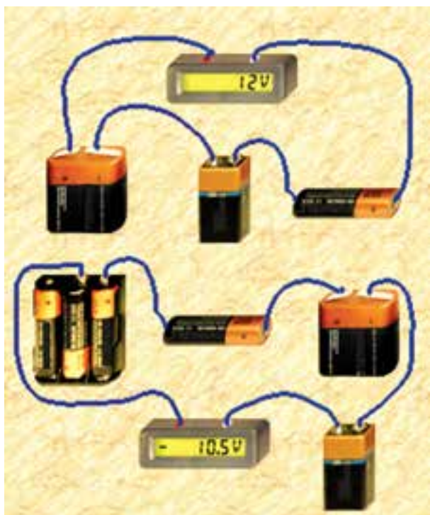
شکل ۴-۵ اندازه‌گیری ولتاژ چند پیل و باتری به صورت سری
