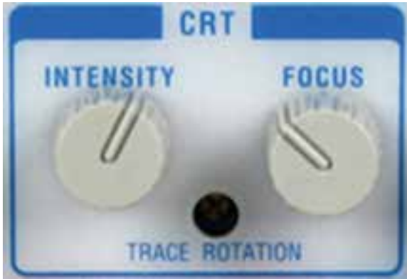
شکل ۵-۶ ولوم‌های تنظیم شدت نور و تمرکز اشعه
