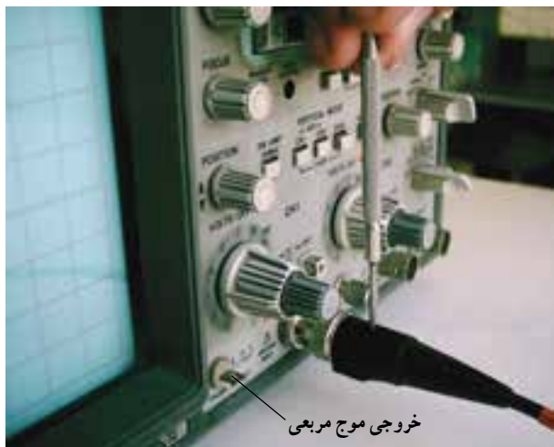
شکل ۵-۱۳ نحوه تنظیم پروب برای مشاهده موج مربعی
