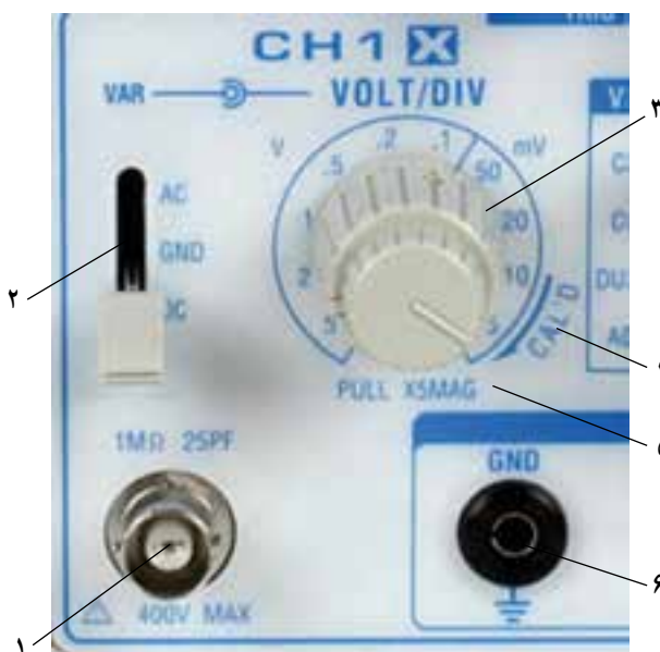
شکل ۱۴-۵- سلکتورها، ولوم‌ها و ترمینال‌های ورودی اسیلوسکوپ
