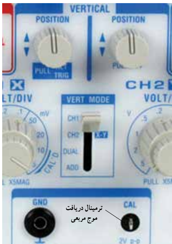
شکل ۱۸-۵- قسمت‌های مشترک و سایر تنظیم‌کننده‌های قسمت عمودی
