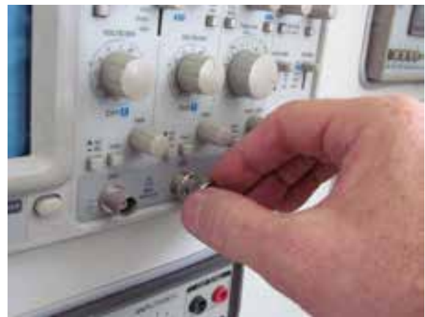
شکل ۵-۱۲ چگونه اتصال BNC به اسیلوسکوپ
