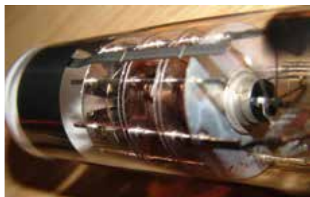
شکل ۴-۵. ساختمان داخلی تفنگ الکترونی
