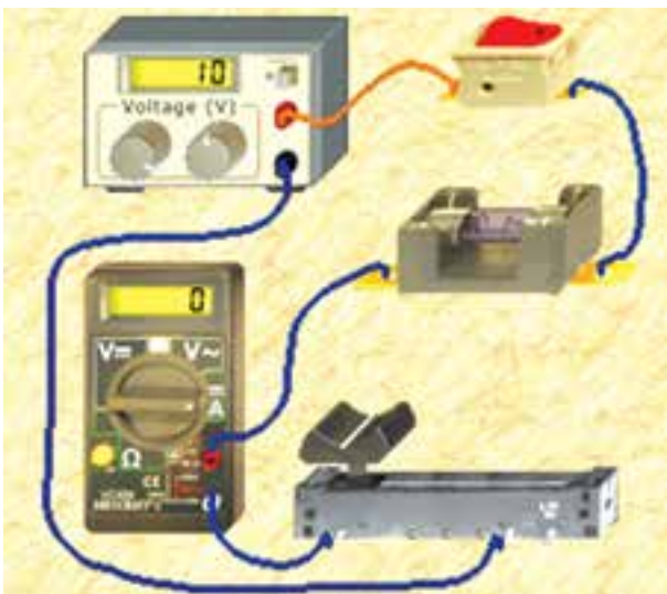
شکل ۱-۱۳ در مدار پتانسیومتر فیوز سوخته است.
