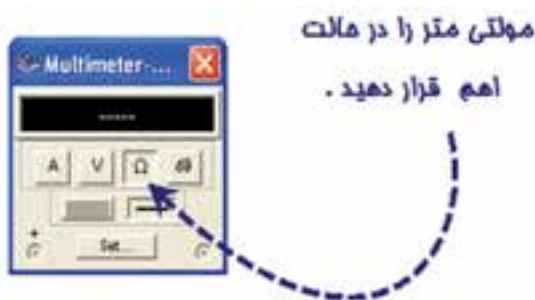
شکل ۲-۶۳ مولتی متر در حالت اهم متر
