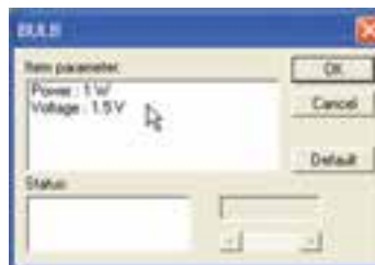
شکل ۱-۳۷ تغییر ولتاژ لامپ از ۵/۶V به ۱/۵V
