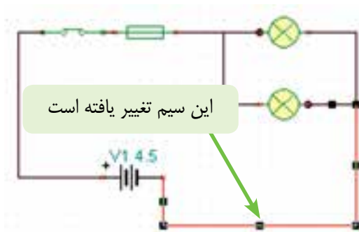
شکل ۱-۵۳ اصلاح نقشه‌ی فنی مدار از طریق جابه‌جایی خطوط و قطعات
