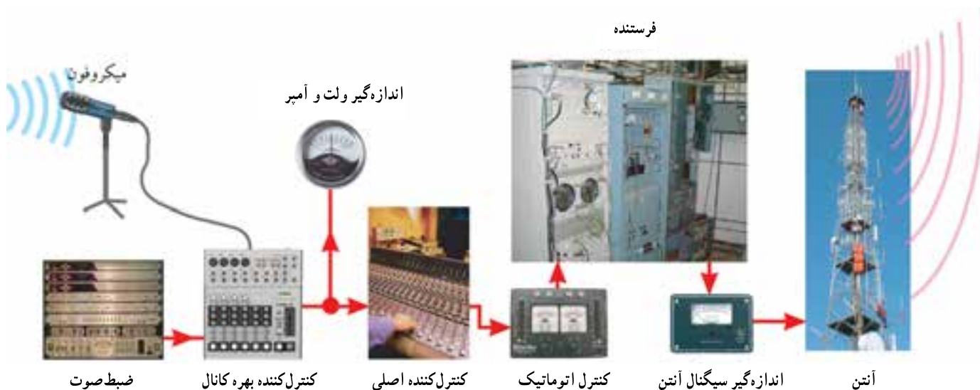
شکل ۱۹-۶- بلوک دیاگرام کلی فرستنده
